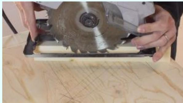
On règle la profondeur de notre scie circulaire à mi épaisseur.
